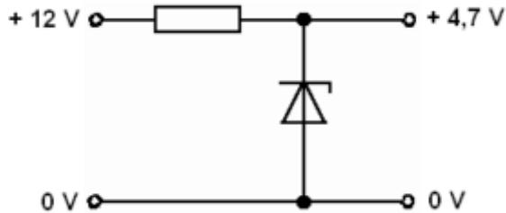
Zwischen dem Vorwiderstand und dem Innenwiderstand der Z-Diode teilt sich die Spannung auf.
