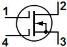
2) **Drain** = Drainage = Abfluß
