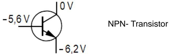
Sofern die Spannung an der Basis eines NPN Transistors um die Schwellspannung positiver ist, als die Spannung am Emitter, fließt ein Kollektorstrom.
