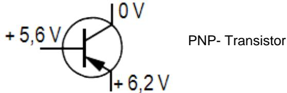
Sofern die Spannung an der Basis eines PNP Transistors um die Schwellspannung negativer ist, als die Spannung am Emitter, fließt ein Kollektorstrom.
