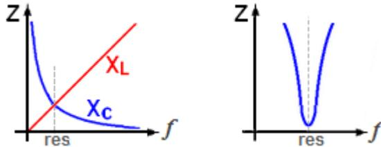
Das linke Diagramm zeigt: Der Wechselstromwiderstand des Kondensators  $X_C$  wird mit zunehmender Frequenz niedriger. Der Wechselstromwiderstand der Spule  $X_L$  erhöht sich dagegen linear mit der Frequenz.
