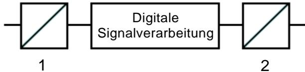
Der AD-Wandler setzt das Analog-Signal in ein Digital-Signal um.
