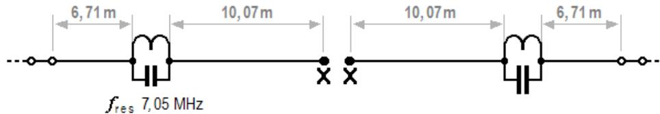
**7-MHz:** Die Sperrkreise sind auf 7,05 MHz abgestimmt, und nur der innere Teil der Antenne strahlt.
