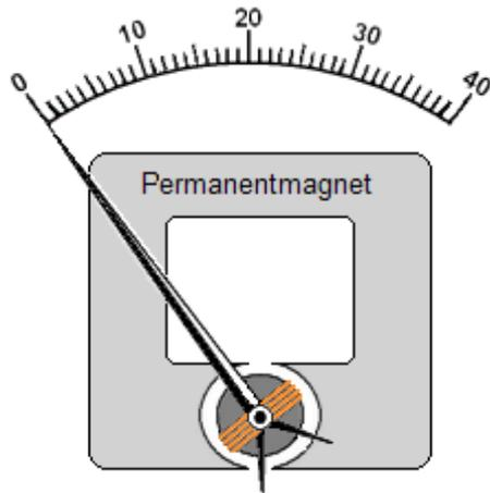
Bei Drehspulmesswerken dreht sich eine Spule infolge des durchfließenden Meßstromes in einem Dauermagneten aus Magneteisen-Blechen.
