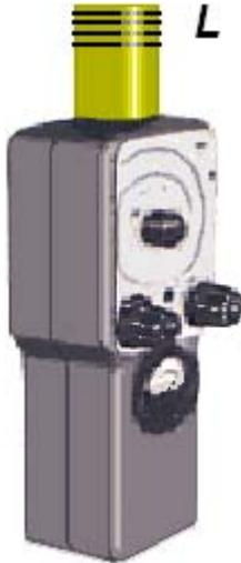
Ein Frequenzmesser zum Ermitteln der Frequenz, z.B. von Schwingkreisen, Antennen usw.
