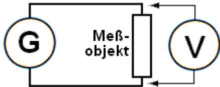
Der hochohmige Spannungsmesser ist **parallel zum**, - und möglichst **nahe am** Messobjekt anzuschließen.
