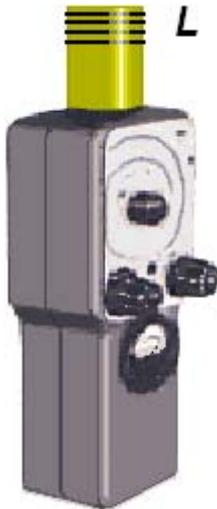
Ein Dipmeter ist ein Frequenzmesser in dem sich ein durchstimmbarer HF-Generator befindet:
