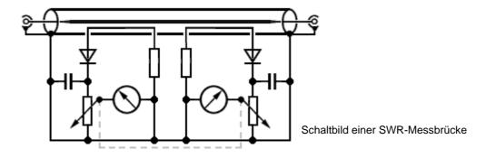
Zwischen Sender-Ausgang und Antenne eingeschleift (in den Weg eingefügt), wird mit einer der beiden Meßleitungen die vorlaufende, und mit der anderen Meßleitung die rücklaufende Welle zur Anzeige gebracht.
