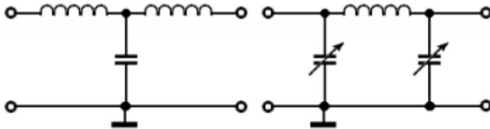
Harmonische und Oberwellen sind immer Frequenzen, die oberhalb der Sollfrequenz ausgestrahlt werden. Abhilfe schaffen Tiefpässe (Oberwellenfilter) am Senderausgang, die die Frequenzen oberhalb des Amateurbandes reduzieren.
