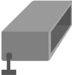
Vervielfacher arbeiten mit unlinearer Kennlinie, was leicht zu Störungen führt. Sie sollten deshalb besonders gut abgeschirmt werden
