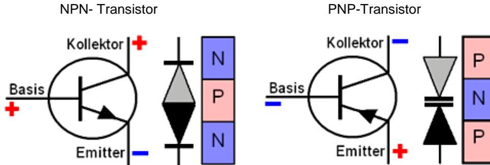
Transistoren "sehen" Spannungen immer vom Bezugspunkt aus - dem Emitter.
