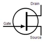
Der Feldeffekt-Transistor verdankt seine Bezeichnung der Tatsache, daß allein ein elektrisches Feld die Steuerung des Transistors bestimmt.
