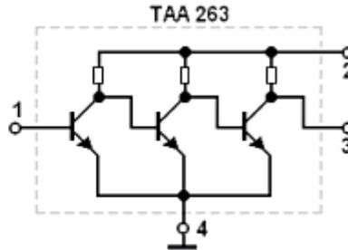
Den Verstärkerstufen wird über die Widerstände eine von Stufe zu Stufe immer höhere Spannung zugeführt.
