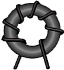
Das Kabel transportiert Gleichtaktsignale (Mantelwellen) und fängt seinerseits zu strahlen an. Mantelwellendrosseln bzw. Trafos dämpfen die Mantelwellen.
