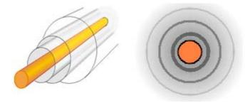
Um den Leiter herum breitet sich koaxial und kreisförmig, ein schlauchartiges Magnetfeld aus, während sich radial ein elektrisches Feld ausbreitet.
