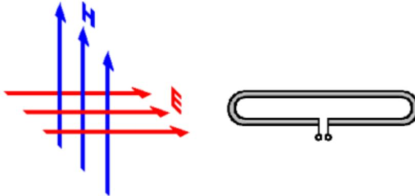
Die horizontal angebrachte Antenne (rechts) strahlt ein horizontal polarisiertes Signal ab, mit der Ebene des E-Feldes.
