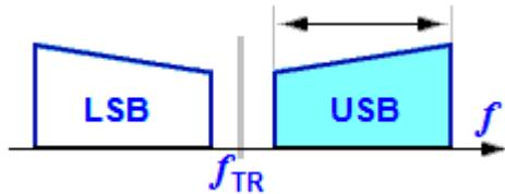
Bei SSB wird der Träger und eines der Seitenbänder unterdrückt.
