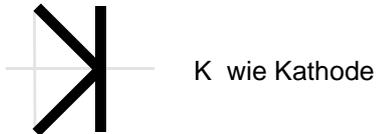
An der Anode (links) liegt eine um 0,7 Volt höhere Spannung.
