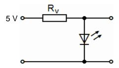
Die Spannung von 5 V teilt sich zwischen Vorwiderstand Rv (3,6 Volt), und der Leuchtdiode mit 1,4 Volt auf.
