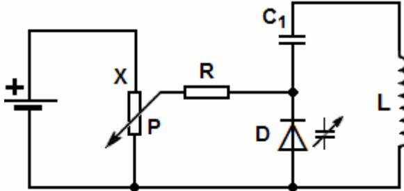
Die Frequenz des Schwingkreises wird mittels Kapazitätsdiode eingestellt. Kapazitätsdioden werden in der Regel in Sperrichtung betrieben, d. h. man vergrößert ihr Verarmungsgebiet mit einer positiven Spannung an ihrer Kathode.
