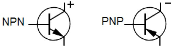
Transistoren “sehen“ Spannungen immer vom Bezugspunkt aus - dem Emitter.
