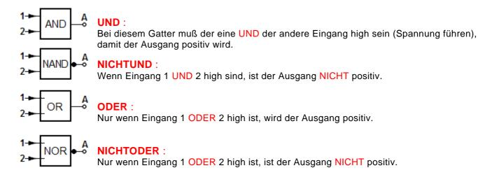
Die Invertierung wird im Schaltsymbol durch den Punkt oder einen Kreis am Ausgang dargestellt.
