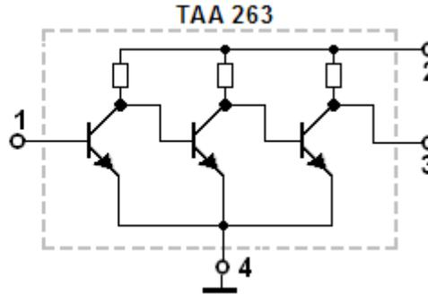
Gleichstromgekoppelte Verstärker haben keine weiteren Bauteile zwischen den einzelnen Verstärkerstufen. Über die integrierten Widerstände gelangt an den Eingangstransistor die kleinste Spannung. Sie wird in den Folgestufen immer größer, damit die Arbeitspunkte jedes Transistors richtig eingestellt sind.
