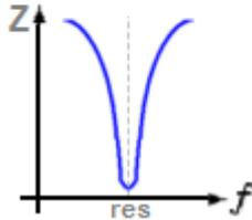
Wie in der Resonanzkurve zu sehen, läßt er alle Frequenzen zum Ausgang durch, solange er hochohmig ist. Nur die Resonanzfrequenz leitet er gegen Masse ab.
