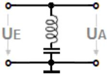
Der Serienresonanzkreis (auch Reihenschwingkreis) ist auf der Resonanzfrequenz niederohmig.
