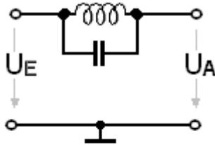
Der Sperrkreis, ein Parallelschwingkreis im Signalweg - ist bei der Resonanzfrequenz hochohmig.
