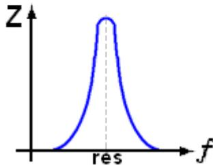
Seine Resonanzkurve zeigt, er läßt alle Frequenzen zum Ausgang durch, solange er nicht hochohmig ist.
