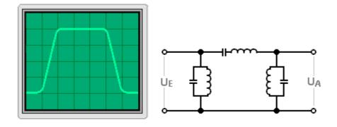
Mehrkreis - Bandfilter werden in der Regel so abgeglichen, daß im Maximum fast keine Höcker oder Einsattelungen auftreten.
