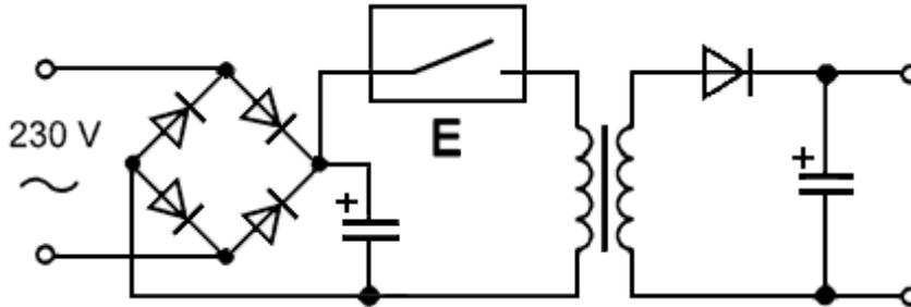
Der elektronische Schalter zur Pulsweiten-Steuerung eröffnet die Möglichkeit, die gewünschte Ausgangsspannung in Grenzen einzustellen.
