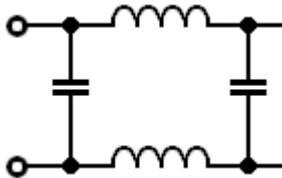
Es geht hier um den Tiefpaß, der höhere Frequenzen über die Kondensatoren unterdrückt, (kurzschließt) während Gleichspannung oder niederfrequente Spannungen über die Spulen ungehindert den Ausgang erreichen. Sowa's fertigt als Netz-Störschutz zu kaufen !
