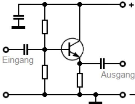
Verstärker in Kollektorschaltung (Emitterfolger) erkennt man daran, daß der Kollektor ohne Arbeitswiderstand an die Versorgungsspannung angeschlossen ist.
