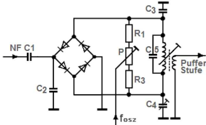
Erkennbar am NF-Signaleingang und dem Ausgang zu einer Pufferstufe ist dies die Stufe eines Senders.
