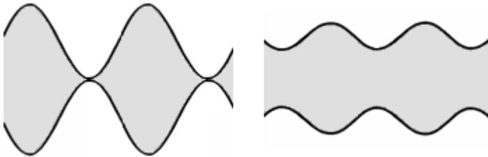
100% Modulationsgrad sind bei AM erreicht, wenn sich die Halbwellen zwar berühren, aber noch keine Verzerrung sichtbar ist. So, wie im linken Bild.
