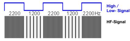
Es wird Audio Frequency Shift Keying eingesetzt: = Ton-Frequenz-Umschaltverfahren.
