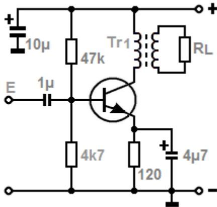
Diese Schaltung kann kein Mikrofonverstärker oder HF-Verstärker sein.
