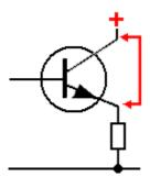
Der Transistor reicht im Falle eines Kurzschlusses des Transistors die Kollektorspannung vom Kollektor zum Emitter durch.
