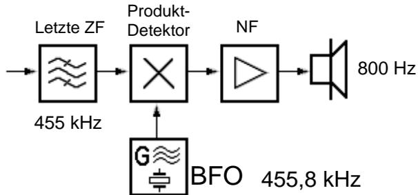
**BFO** ist aus dem Englischen **B**eat **F**requency **O**scillator abgeleitet. Es ist ein Hilfsfrequenz-Oszillator, dessen Frequenz im Falle des CW-Empfangs um die gewünschte NF-Tonhöhe (ca. 800 Hz) oberhalb oder unterhalb der ZF-Frequenz liegt.
