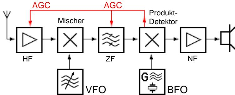
Die **AGC** = **A**utomatic **G**ain **C**ontrol = Automatische Verstärkungsregelung wird im Produktdetektor gewonnen.
