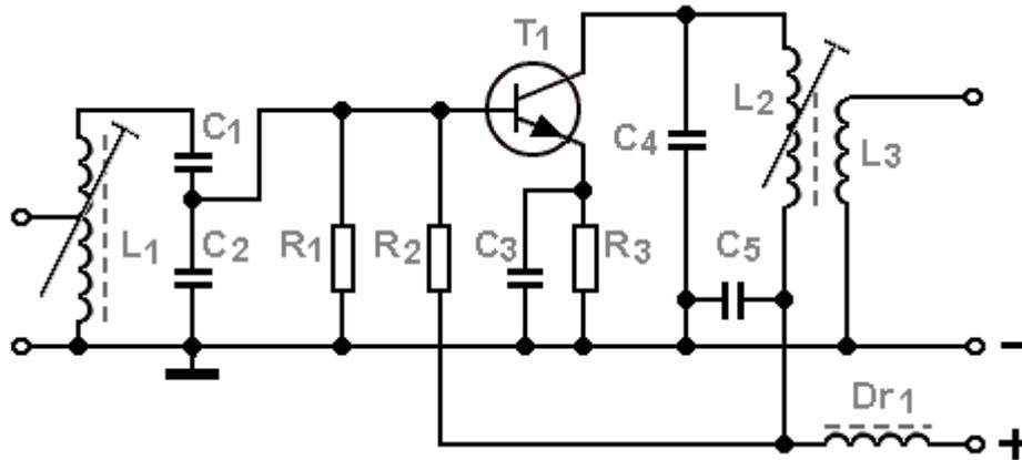
HF-Verstärker haben in der Regel Schwingkreise im Eingang und Ausgang. Daran erkennt man sie zum Beispiel.
