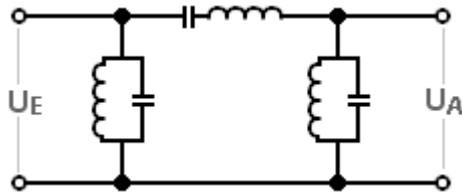
Der Bandpaß aus zwei Parallelschwingkreisen und einem Leitkreis wird so abgeglichen, daß ein gewünschtes Frequenzband durchgelassen wird. Alle anderen Frequenzen werden sehr wirksam gesperrt.
