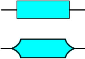
CW ist das Ein- und Ausschalten des Senders mit der Morsetaste. Die auf diese Weise erzeugten Rechtecksignale stören sowohl das Ohr, als auch die Nachbarfrequenzen.
