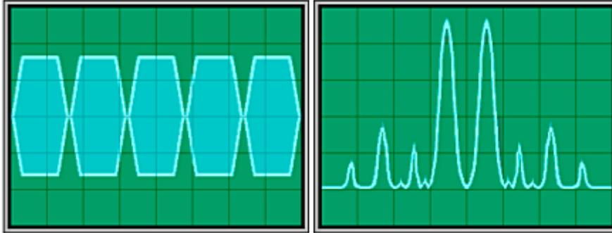
Das Signal wird in den Modulationsspitzen begrenzt. (Oszilloskop-Bild links).
