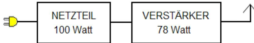
Das Netzteil benötigt hier 100 Watt, um den Verstärker zu speisen, der daraus = 78 Watt HF produziert.
