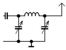
Zur wirksamen Unterdrückung von Oberwellen, und zur Impedanzanpassung zwischen Röhre und Antenne wird allgemein der Tiefpaß angewendet.
