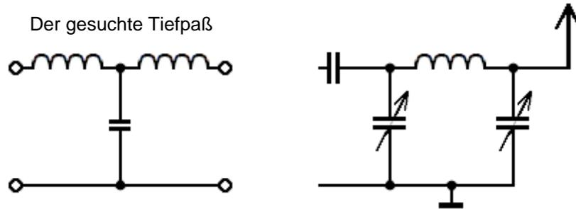
Oberwellenausstrahlung verhindert man mit einem Tiefpaß.
