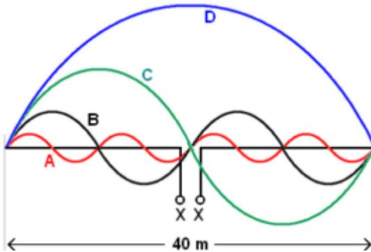
Der Dipol ist 40-m lang, = 8 Halbwellen bei 28 MHz.
