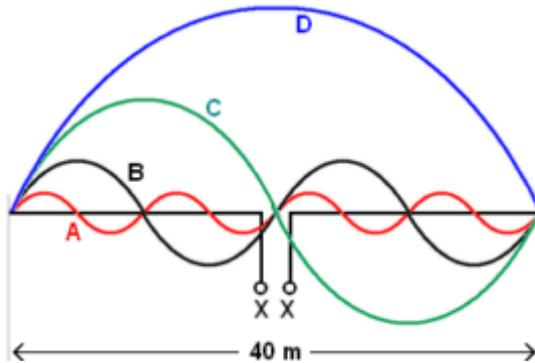
Der Dipol ist 40-m lang, = 1 Halbwelle bei 3,5 MHz.
