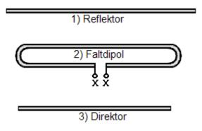
Die Annäherung der Elemente an den Strahler hat eine kapazitive Belastung zur Folge.
